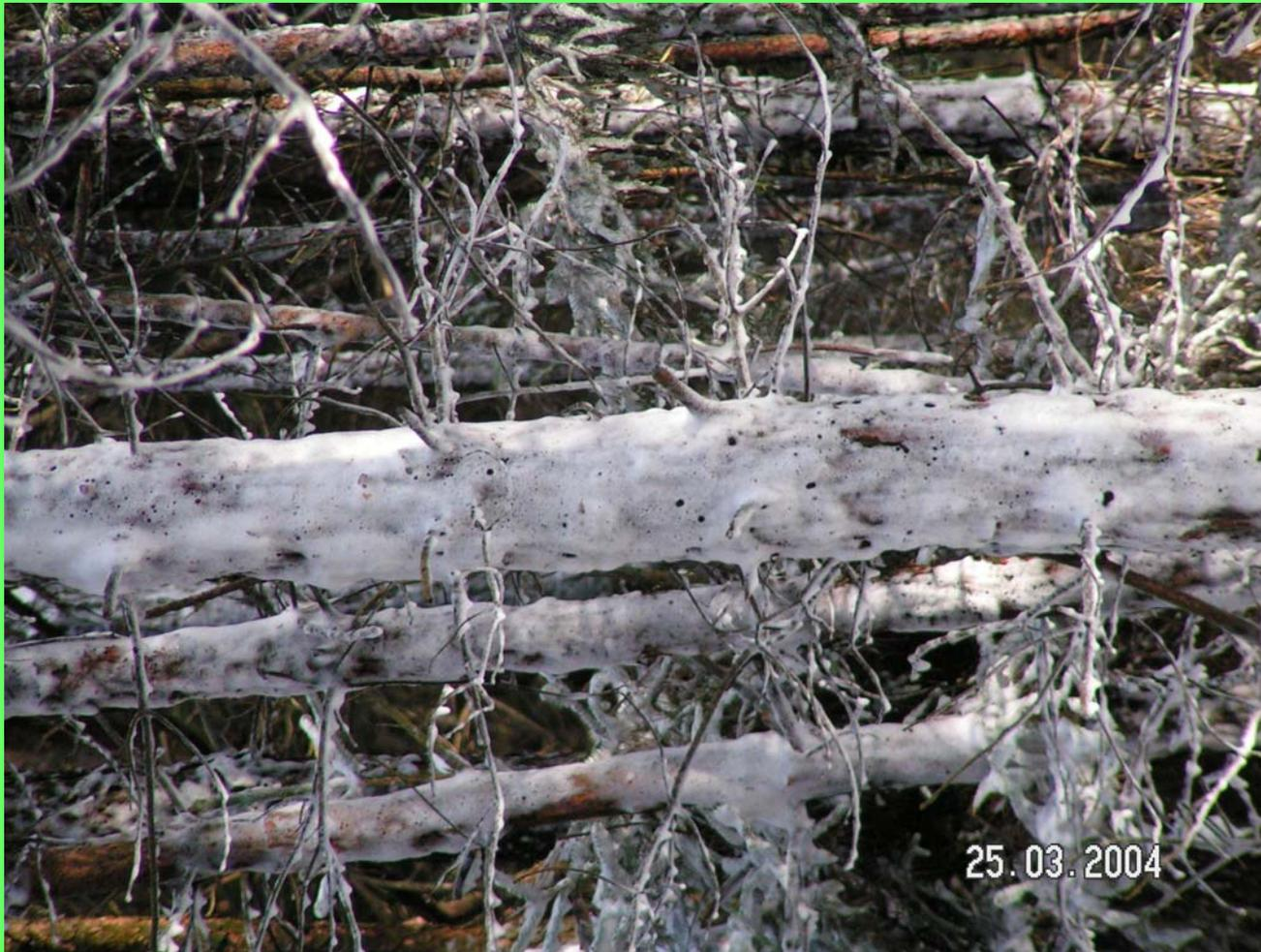
Der Schaum von “Classs A-Foam”, der mit 0,3% – 0,5% dem Wasser zugemischt wird, bleibt über 30 Minuten lang an den Bäumen haften.
