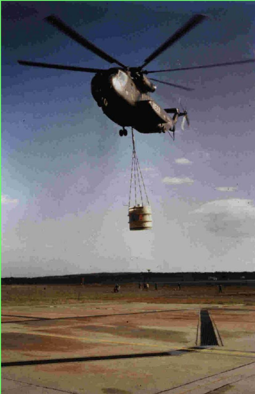
Anstelle des Starrflüglers setzte man für die Waldbrandbekämpfung aus der Luft in Westdeutschland auf den Hubschrauber mit Löschwasseraußenbehälter.
